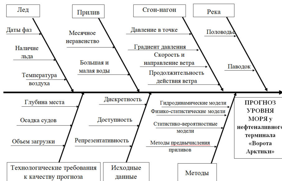
Рис. 1. Причинно-следственная диаграмма факторов, определяющих оправдываемость прогноза уровня моря у мыса Каменный (Обская губа Карского моря)
