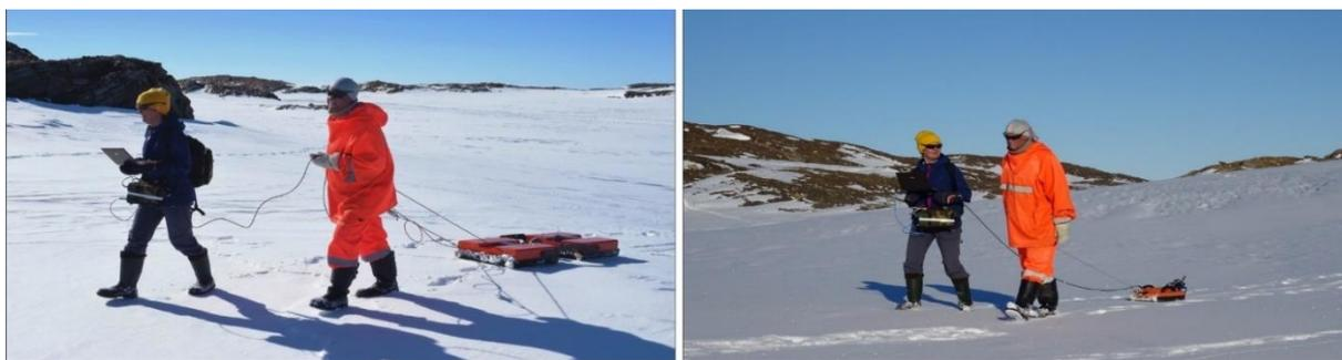
Рис. 2. Выполнение георадарной съёмки.
